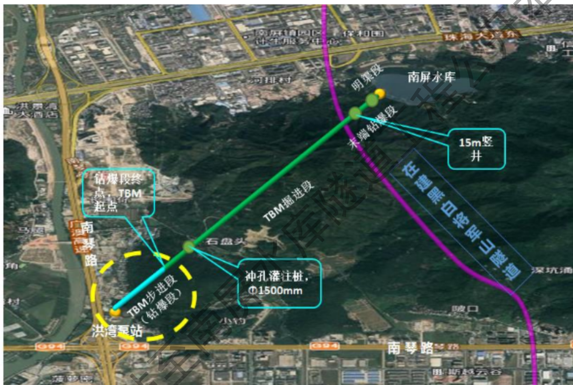
图 3.5-1 隧洞段平面示意图
